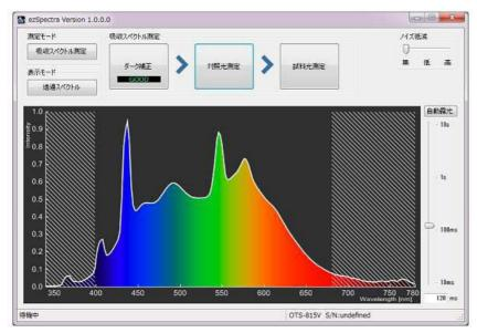
次に、測定対象のサンプルを通した光を入射して、「試料光測定」ボタンをクリックしてください。測定完了後、自動的に結果表示画面に移行します。
