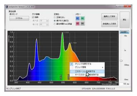
結果表示画面では、最大4つまでの過去の測定結果と現在の測定結果のスペクトルを、重ね合わせて表示することができます。
