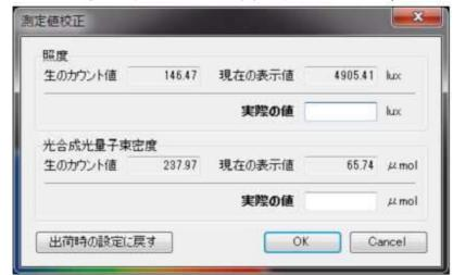
PPFD は、6500K 昼光色蛍光灯に 最適化して出荷しています。 各光源を測定する際は、蛍光灯は 表示値通り、太陽光は×0.93、LED は×0.85~0.92(レンズ集光 LED は 0.92)で換算してください。
