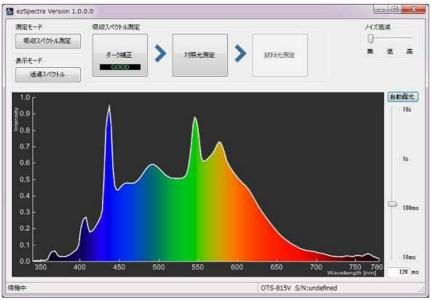
まず、なにも通さない対照光を入射して、「対照光測定」ボタンをクリックしてください。 スペクトル強度が弱すぎて十分な測定品質を期待できない範囲には、斜線がかかり測定から除外されます。 なるべく、鋭いピークがない(滑らかな)スペクトルの光源を使用してください。
