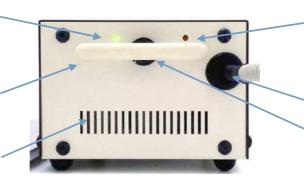
エラー表示LED (故障、断線、異常過熱が あると点灯します)
